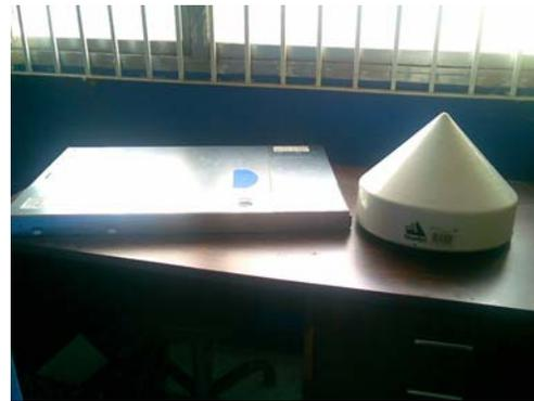
Fig. 3: Tipos de receptores GPS y antenas de las estaciones REMOS
