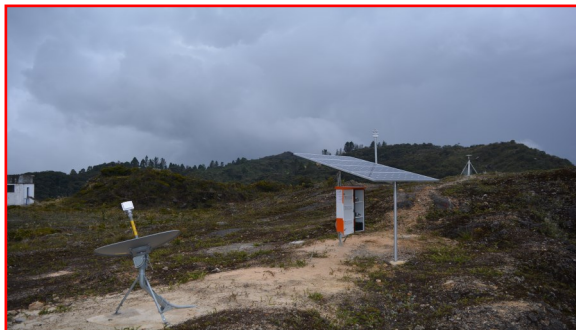
Figura 2. Arquitectura de una estación permanente con propósitos geodinámicos
